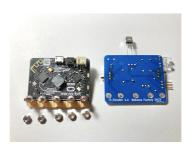
基板を裏返しにして、穴にビスを通し、 ナットで緩まないように固定します。
