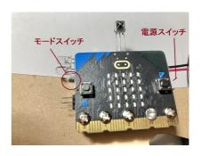
標的を離れた場所に置き、光線銃で狙いをつけます。 光線銃のmicro:bitのボタンBを押すと、赤外線が発射されます。 標的のセンサーに当たると、LEDが点灯します。 プログラムを工夫して、もっと楽しくしてみてください。
